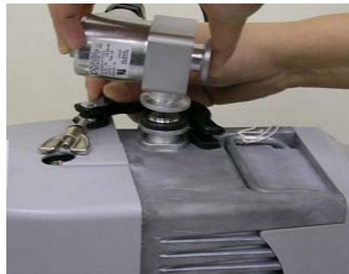
Figura 9 Montaje de válvula de entrada con bomba IDP-3
